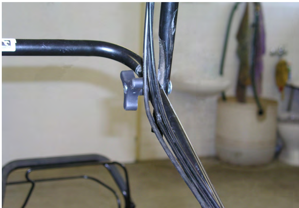
Obr. č. 9. Všechny lanovody musí být vedeny tak, aby nebyly poškozovány při skládání model sekačky.
